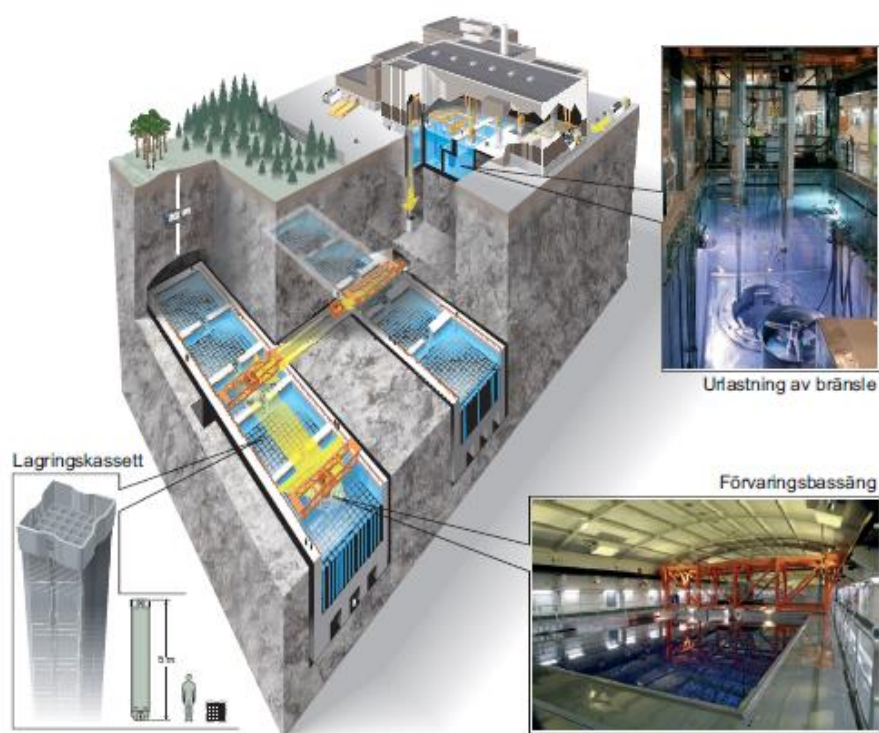
Figur 6. Det centrala mellanlagret för använt kärnbränsle, CLAB 32 .
