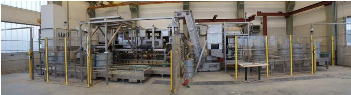
Abbildung 7: Erdmessenanlage (rechts Materialaufbringung, links Messung und Separation)
